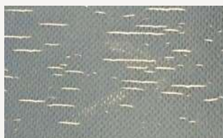
Vista ampliada de las fundas de colchones dañadas por productos químicos y abrasión donde empiezan a producirse daños por transparencia*
