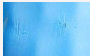
Vista ampliada de las fundas de colchones dañadas por productos químicos y abrasión donde empiezan a producirse daños por transparencia*
